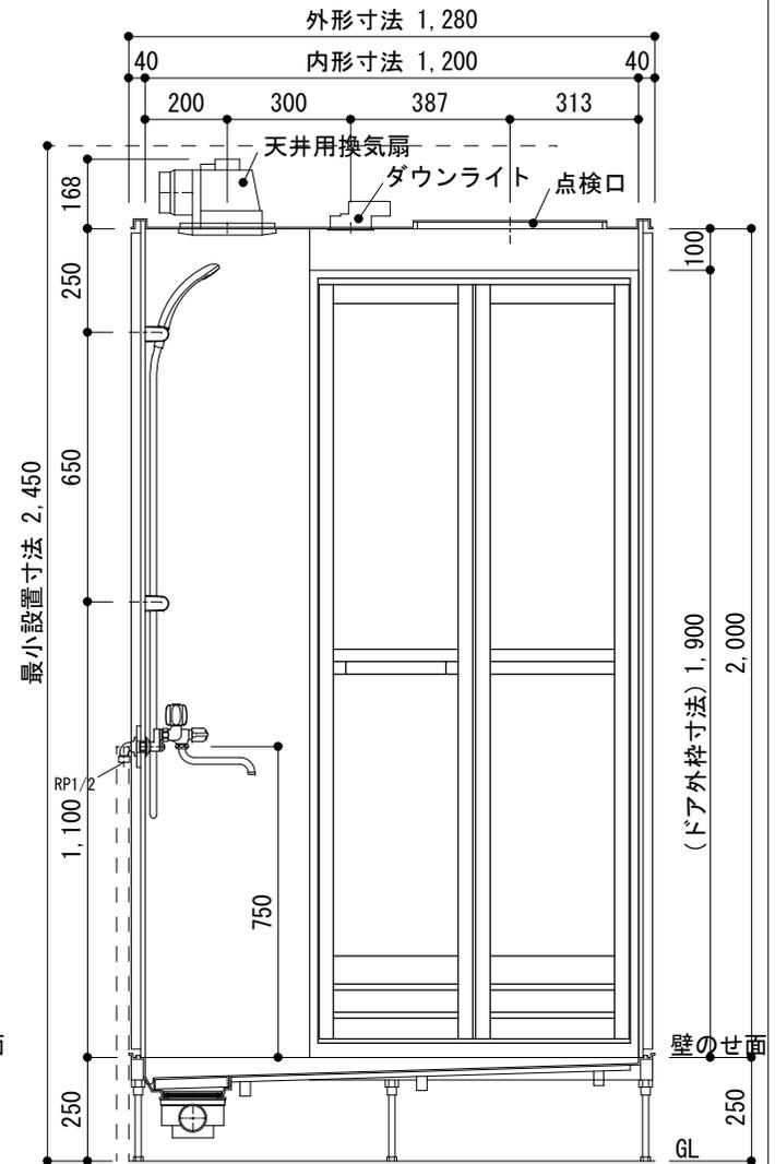
※給湯・給水管は可とう性の管で高さに余裕をもって設置ください。
