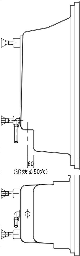
※ 本製品は、腰壁から下のみとなります。壁、天井、シャワー水栓、鏡、照明などは現場手配、現場施工です。
